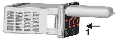
Situar ENDAKEY-RF junto a la parte superior izquierda del dispositivo en dirección 1.
